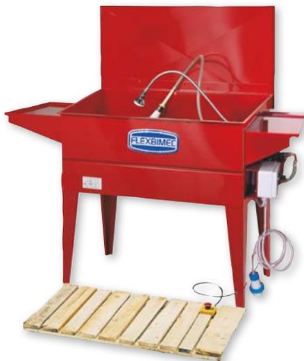
Máquina para el lavado de piezas de acero pintado de circuito cerrado con bañera de 500x1000x1120 mm. con sistema de recirculación del líquido a 0,5 bar de presión a través de una bomba ELECTRICA DE INMERSIÓN. El encendido y apagado de la bomba se realiza a través de un interruptor de pedal.
