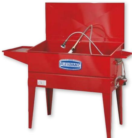
Máquina para el lavado de piezas de acero pintado de circuito cerrado con bañera de 500x1000x1120 mm., sistema de recirculación del líquido a través de una bomba rotativa neumática art. 1058 de ACERO INOXIDABLE.
