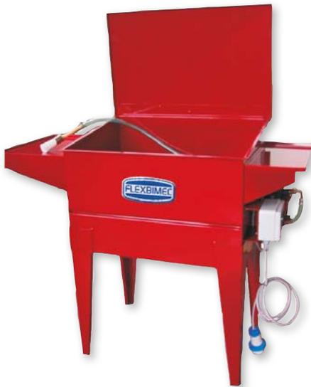
Máquina para el lavado de piezas de acero pintado de circuito cerrado con bañera de 500x700x1120 mm con sistema de recirculación del líquido a 0,5 bar de presión a través de una bomba ELECTRICA DE INMERSIÓN. El encendido y apagado de la bomba se realiza a través de un interruptor de pedal.
