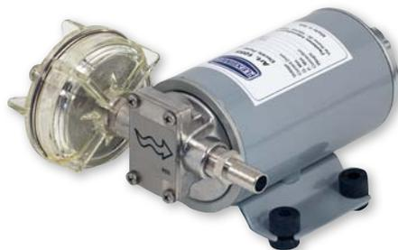
Bomba de engrenagem elétrica, auto-carregadora, 12 Vcc, 24 Vcc ou 230 V, particularmente adequada para o uso de fluidos químicos ou em aplicações onde o uso de peças em aço inoxidável é necessário. Resistente à maioria das soluções ácidas e alcalinas. Adequado também para a transferência de ácido da bateria. Inclui um filtro em linha. Corpo e eixo em aço inoxidável AISI 316, engrenagens em PTFE, juntas em flúor elastomérico.
