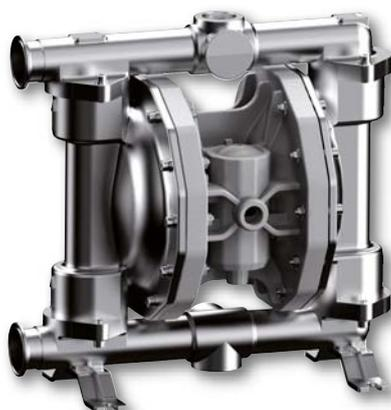
Bomba pneumática de duplo diafragma, para a transferência de fluidos e produtos químicos. Corpo da bomba em aço inoxidável AISI 316, diafragma em Hytrel + PTFE, esferas em PTFE, assentos em aço inoxidável, anel o-ring em PTFE.
